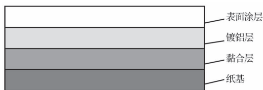
图 1 镭射纸结构示意图
