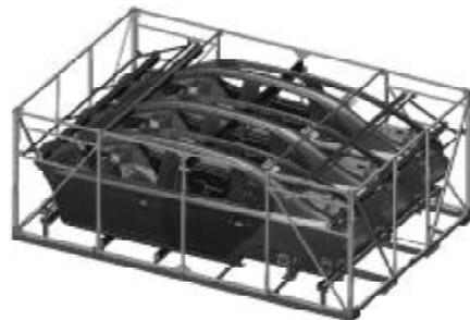
图6 总成侧围包装
