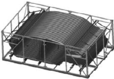
图7 散件侧围包装
