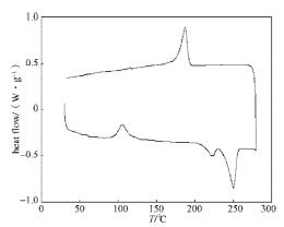
图 1 PET/PBT 合金的一次加热 - 冷却 DSC 图像 Fig. 1 DSC thermograms of PET/PBT blends: heating and cooling once at 10 ℃/min
